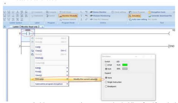
5. Después del paso 4, aparecerá un nuevo cuadro de diálogo [modificar el valor del dispositivo]. En este punto, ingrese el valor al componente, como ON, OFF. La operación específica es la siguiente:
