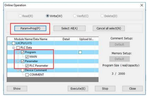
2. Haga clic en el botón [Ejecutar], el sistema abrirá automáticamente una ventana. Haga clic en [Sí] para "detener" el PLC desde el modo "ejecutar" y comenzar la descarga. Haga clic en [no] para no "detener" el PLC y no descargará el programa al PLC como se muestra a continuación (si el interruptor (modo) del PLC ya está en el modo "detener", esta ventana no aparecerá).
